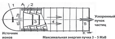
Рис. 4. Схема электростатического ускорителя. 1 – источник ионов; 2, 3 – ускоряющие электроды; 4 – электрическое поле; 5 – выводимый пучок
